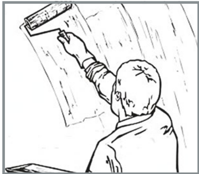
Підготовка стіни до укладання облицювального каменю.
