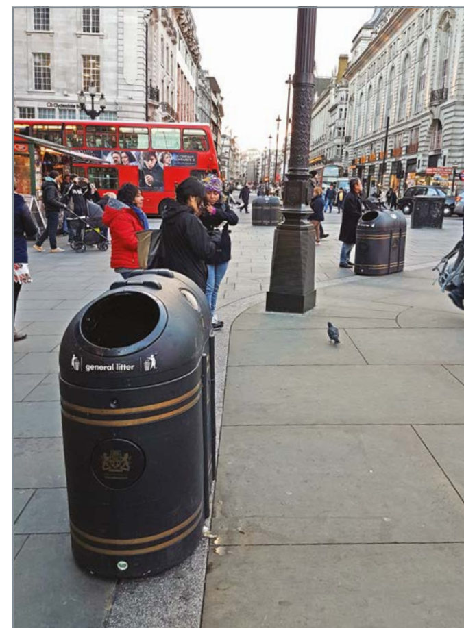
Урна. Пластик. Разделение мусора для вторичной переработки. Широкоформатные тротуарные плиты без фаски с тонкими швами для удобства передвижения. Бетон.
