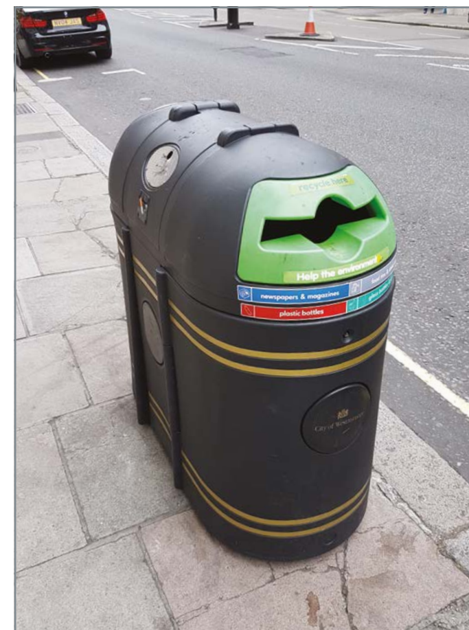
Урна. Пластик. Разделение мусора для вторичной переработки. Широкоформатные тротуарные плиты без фаски с тонкими швами для удобства передвижения. Бетон.
