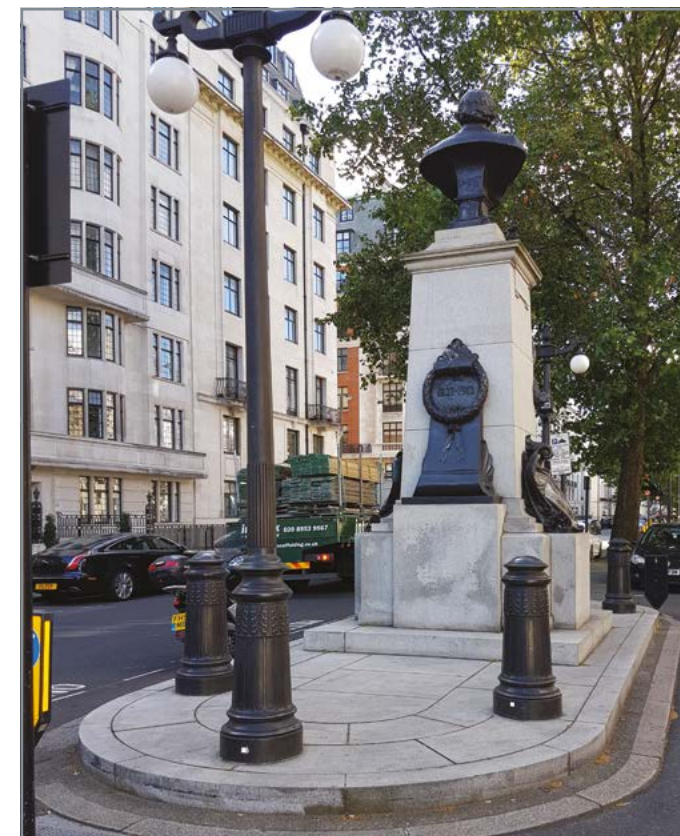
Боллард. Чугун. Забетонирован в тротуар на 30см. Болларды вместе с фонарем и памятником образуют единую композицию. Боллард и фонарь защищают островок от наезда транспорта.
