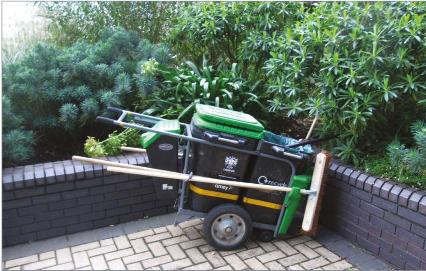
Тележка для уборки мусора. Используется работниками коммунальных служб. На ней перевозится рабочий инструмент (метла, щетка для подметания, совок) и собранный мусор. Облегчает работу дворнику, так как ему ничего не надо носить в руках.
