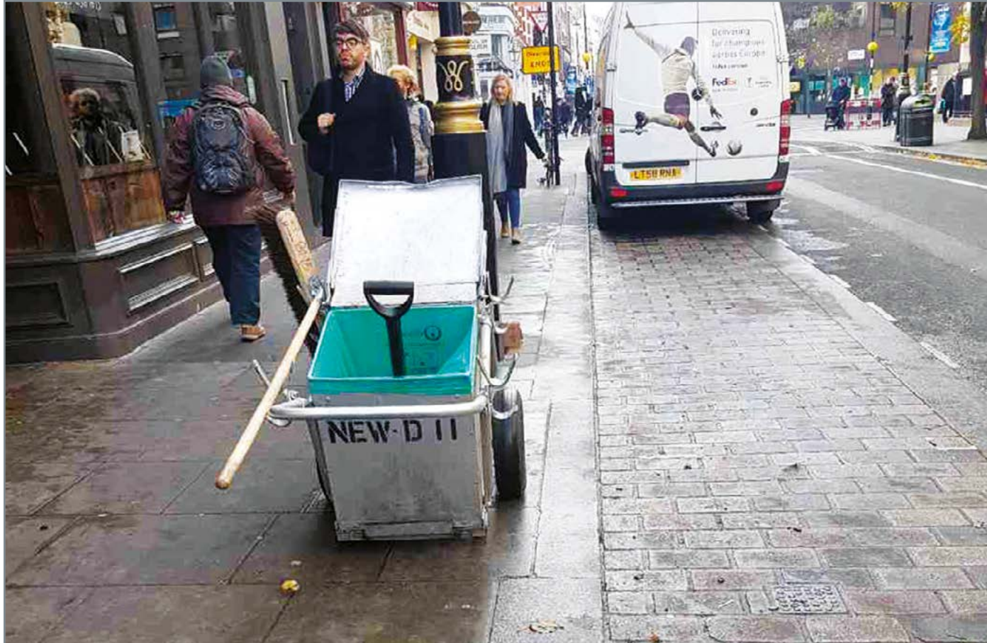
Тележка для уборки мусора. Используется работниками коммунальных служб. На ней перевозится рабочий инструмент (метла, щетка для подметания, совок) и собранный мусор. Облегчает работу дворнику, так как ему ничего не надо носить в руках. Выполнена из оцинкованного металла.
