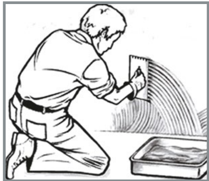
Нанесення клейової мастики на стіну
