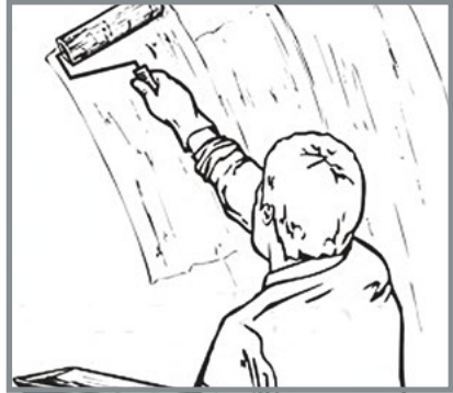
Підготовка стіни до укладання облицювального каменю.
