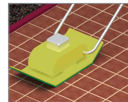
10. Трамбовка тротуарної плитки.
