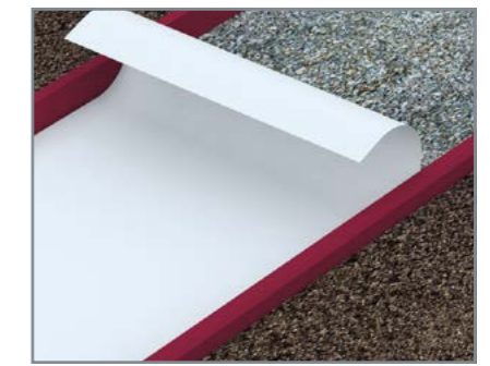
6. Укладання голкопробивного геотекстилю (щільність 120г / м2).
