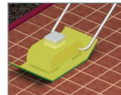
10. Трамбовка тротуарної плитки.
