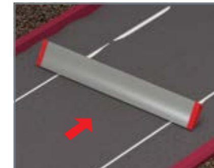
8. Засипка баластного шару з відсіву (фракція 0-5) і стягування зайвого по напрямних.
