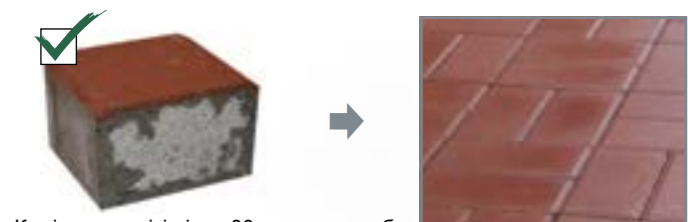
Камінь в розрізі після 30 хвилин перебування у воді, мокрий тільки по краях.
