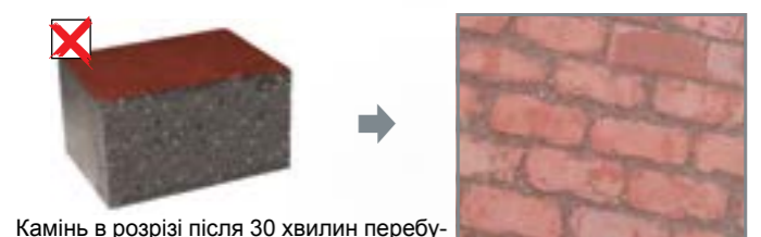
Камінь в розрізі після 30 хвилин перебування у воді, мокрий повністю.
