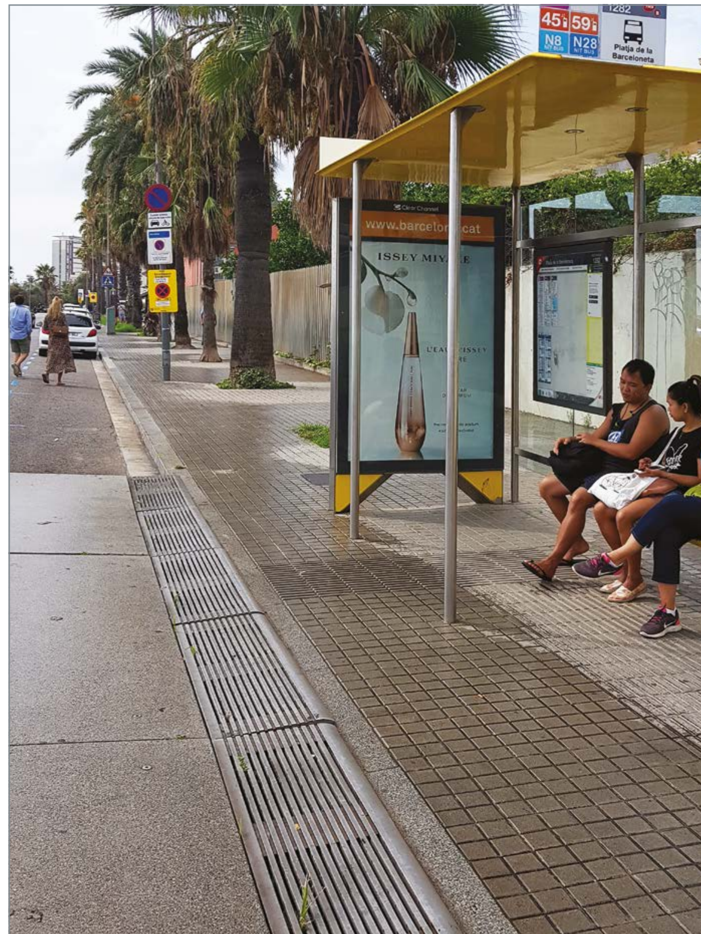
Автобусная остановка с освещением. Материалы: металл, пластик, стекло. Приподнятая бетонная площадка для удобства посадки.
