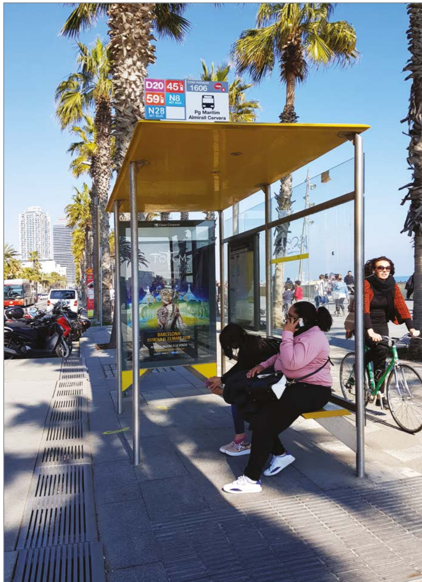
Типичная автобусная остановка с расписанием движения. Приподнятая бетонная площадка для удобства посадки.
