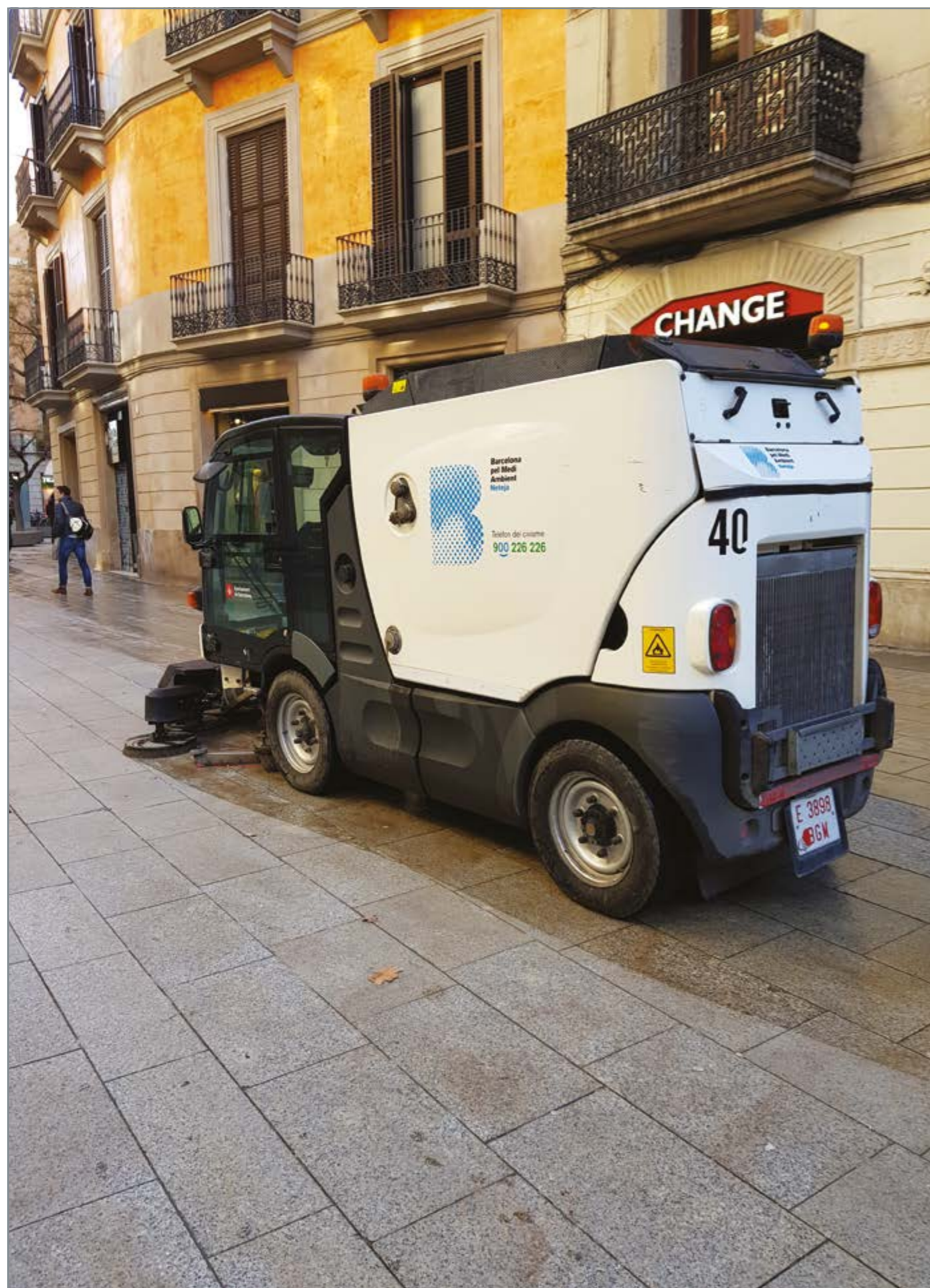
Мусороуборочная машина с пылесосом и щетками для мытья покрытия.
