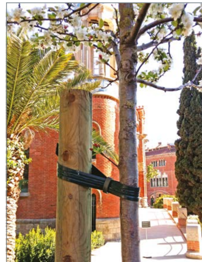
Система крепления дерева. Поддерживает дерево в вертикальном положении.
