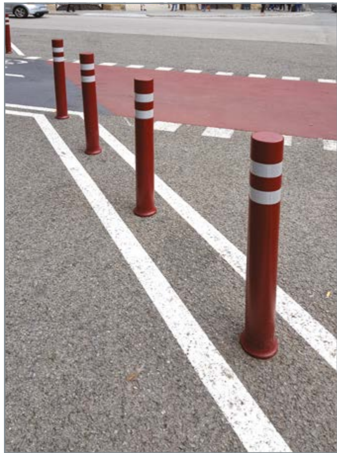
Болларды со светоотражающими полосками на дорожной разметке.
