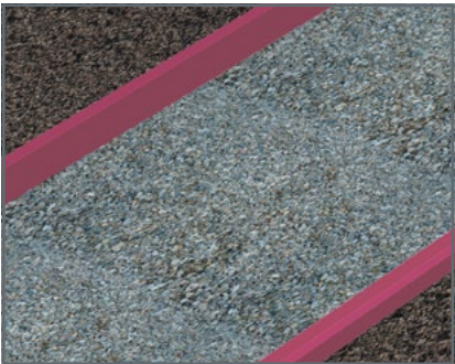
5. Установка поребриків в бетонний замок на ущільнену основу.
