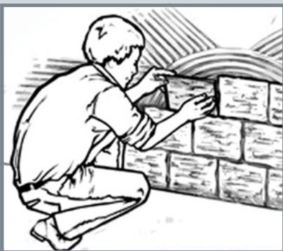
Укладання облицювального каменю на стіну
